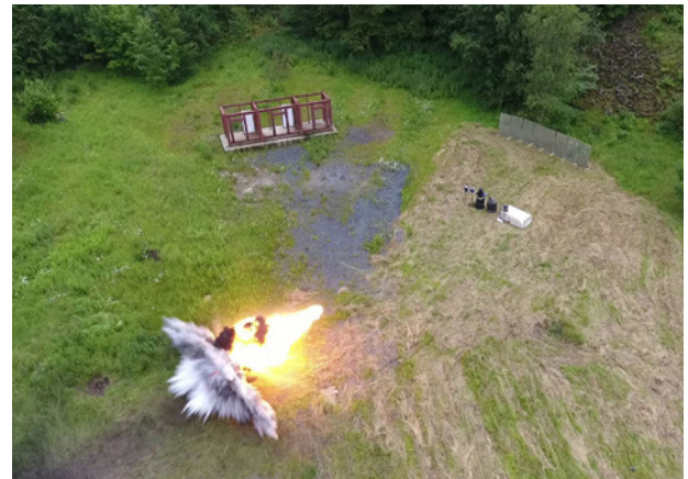
Sprengversuch des Bundeskriminalamts zur experimentellen Ermittlung des Schadensbildes einer unkonventionellen Sprengvorrichtung. (Quelle: Bundeskriminalamt)
