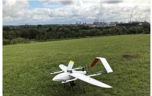
Bild einer Testdrohne, wie sie für die Inspektion im Hamburger Hafen eingesetzt wird.
