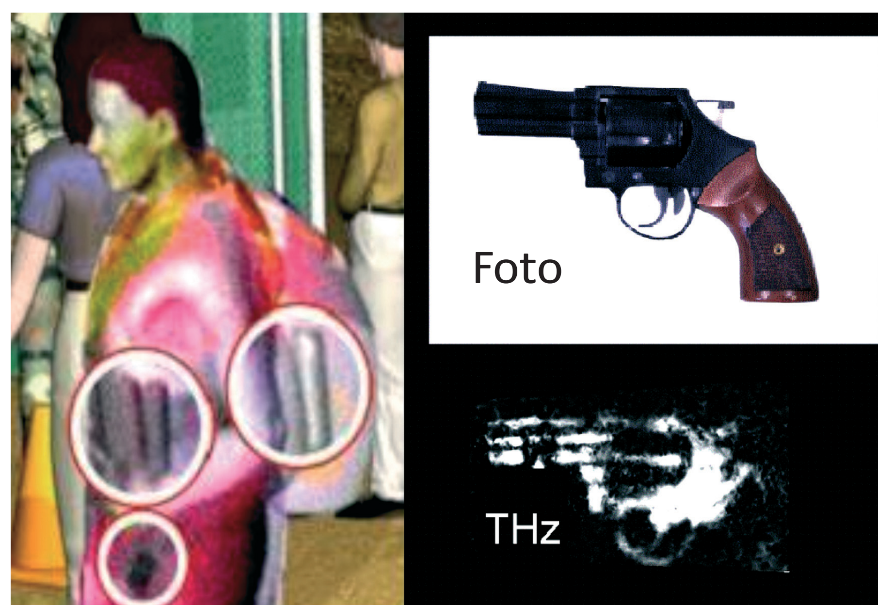
Checkpoint-Szenario und experimentelles, in zehn Sekunden aufgenommenes THz-Bild einer unter Kleidung verborgenen Waffe (Quelle: GE (links); Uni-Ffm / RPG)
