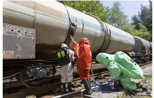
Durch ein mobiles Detektionssystem können die Einsatzkräfte die Gefährdungslage schnell und sicher beurteilen.
