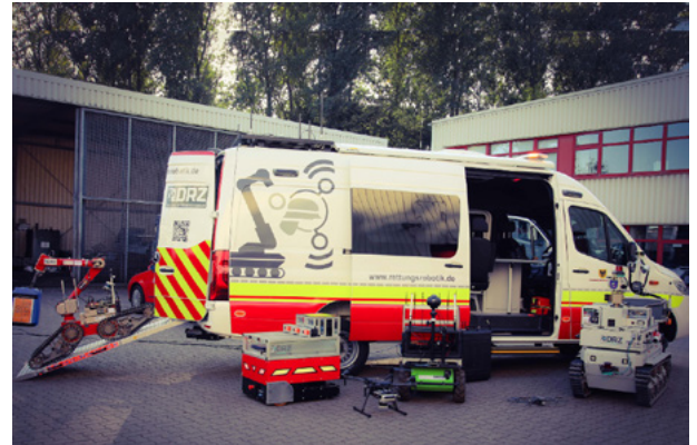
Einsatzleitwagen RoblW des DRZ mit rettungsrobotischen Systemen
