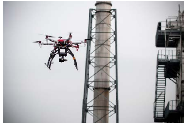
Brandinspektion von kritischen Infrastrukturen zur Gefahreinschätzung aus der Luft (Quelle: © iStock.com/Marco Maccolini)
