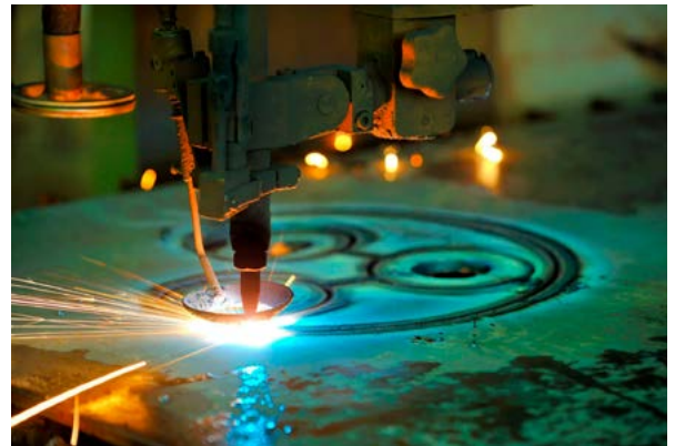
Einkerbung einer Stahlplatte mit Hilfe eines Laserstrahls. (Quelle: © Laurentiu Iordache/Fotolia.com)
