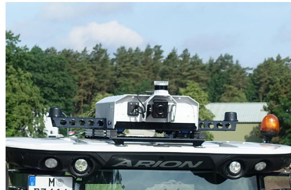
Das Sensor-Kit zur Automatisierung von Nutzfahrzeugen wurde im Projekt AKIT-PRO entwickelt.
