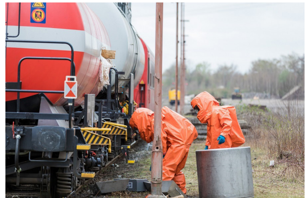
Austritt gesundheitsgefährdender Flüssigkeit aus einem Tankwagen
