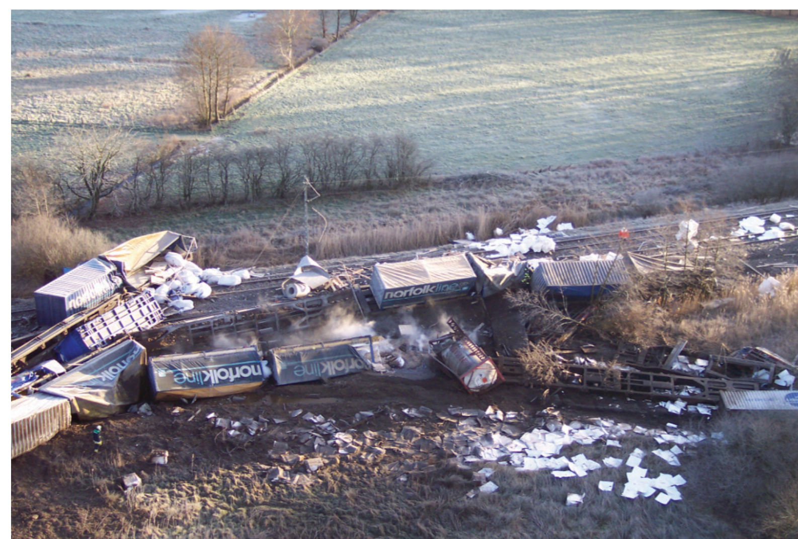
Entgleisung eines Güterzuges bei Hamburg mit Freisetzung von Chloressigsäure (Quelle: DACHS)
